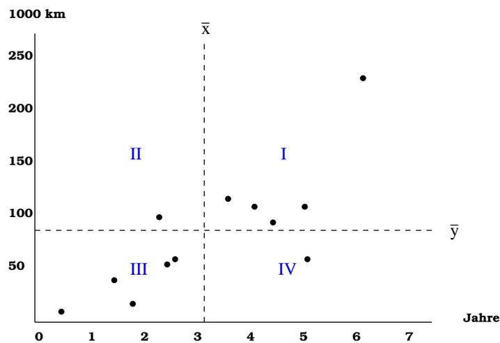
**Sektor I:**  $x_i > \bar{x}$  und  $y_i > \bar{y}$  also  $(x_i - \bar{x}) \cdot (y_i - \bar{y}) > 0$
