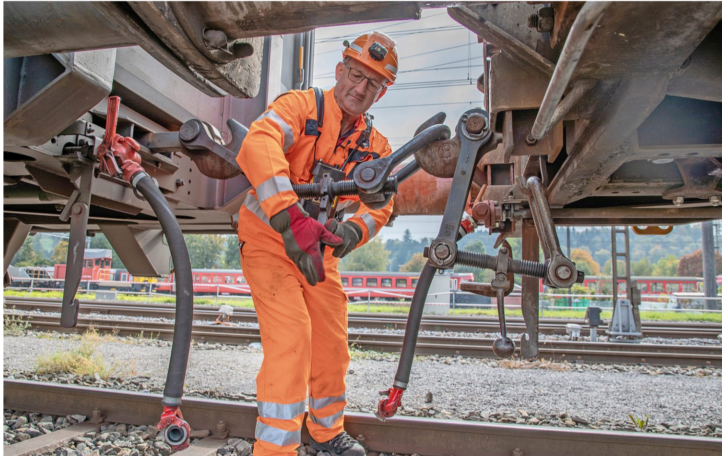
Bald ein Bild der Vergangenheit? Zurzeit muss die schwere Kupplung von Hand bedient werden. Foto: SBB
